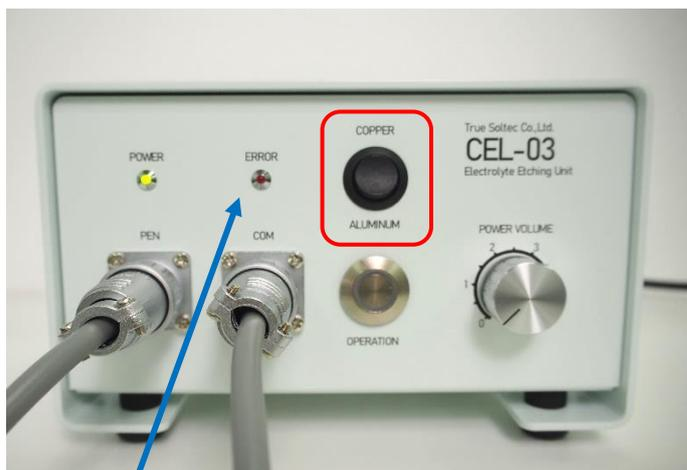
スイッチの選択が異なった場合はエッチングが反応しません。被対象電線の材質を確認しスイッチを選択してください
