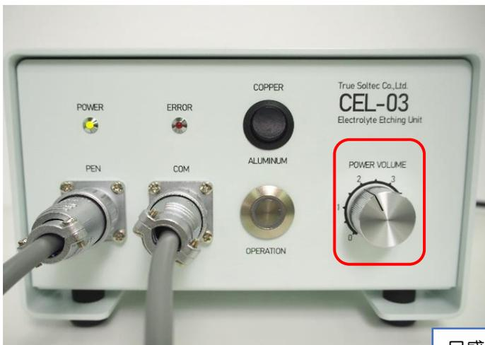
ボリュームを時計回りに回すと大きな電流が流れ太線でも短時間でエッチング出来るようになります。
