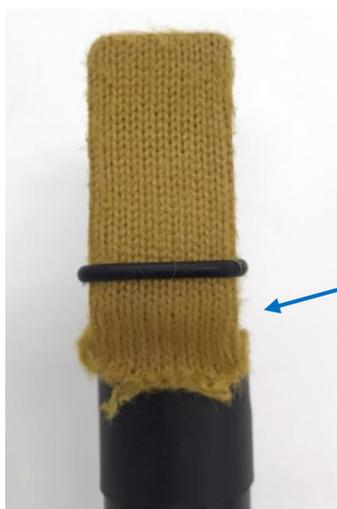
エッチングペン先の金属部が全てペンモップで覆われているかを確認してください。
