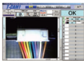
电线颜色排列检查
